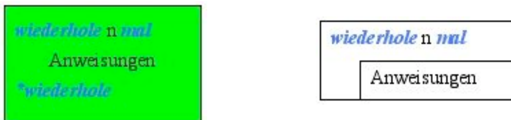
Abbildung 3.6: Die Kontrollstruktur wiederhole ... mal
